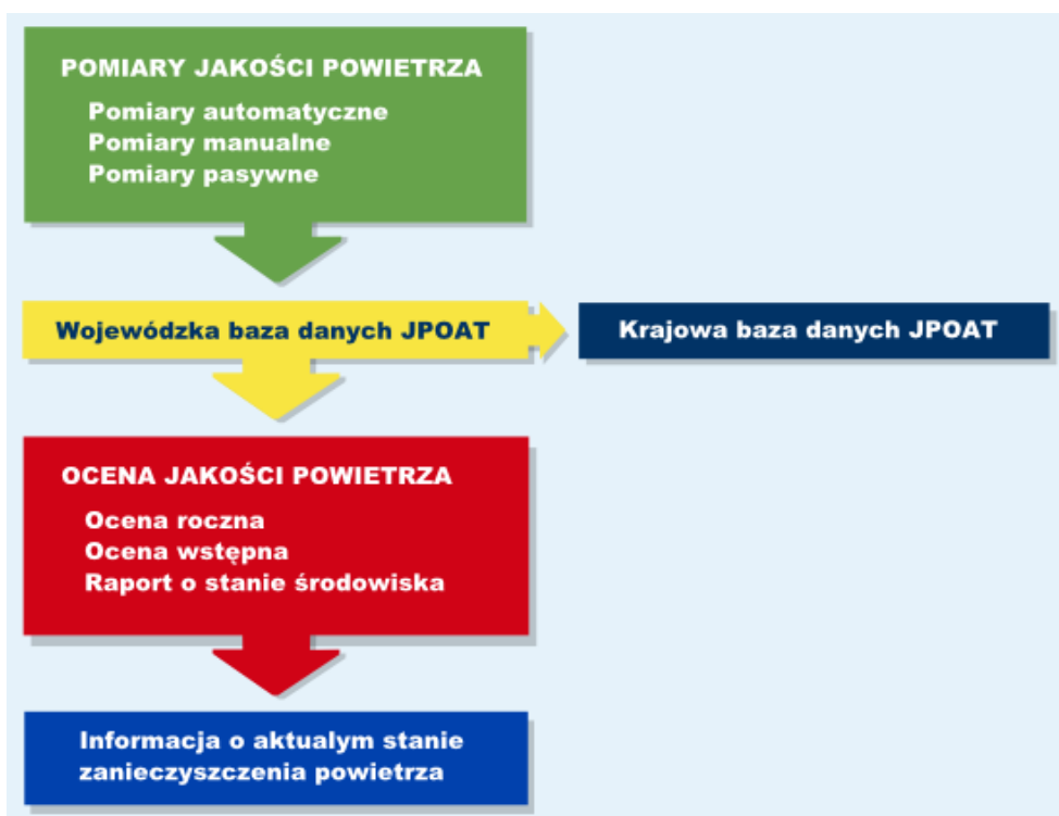
Rysunek 4.1 Schemat funkcjonowaniu monitoringu ochrony powietrza
